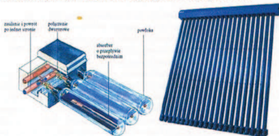
Rysunek 7.9. Budowa i wygląd – kolektor próżniowy
